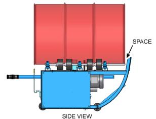
POSITION WHEELS ON EITHER SIDE OF DRUM RIBS
